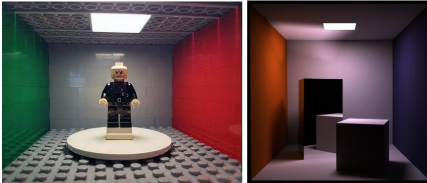
Exemples de génération de scène maîtrisée type Cornell Box, permettant d'étudier la propagation de la lumière par lancer de rayon ; (gauche) scène réelle ; (droite) scène simulée (note : ici les deux scènes ne sont évidemment pas identiques)
