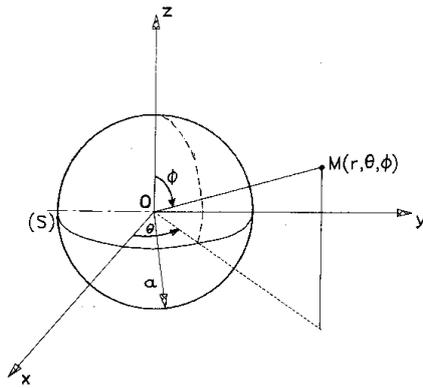
On fait ici deux hypothèses : (i) la surface vibrante  $S$  est une sphère de rayon  $a$ , et (ii) la vitesse normale  $U$  est axisymétrique d'axe  $Oz$  (et il en est donc de même pour le champ de pression). Dans un système de coordonnées sphériques  $(r, \theta, \phi)$ , toute distribution  $U$  axisymétrique sur  $S$  est de la forme
